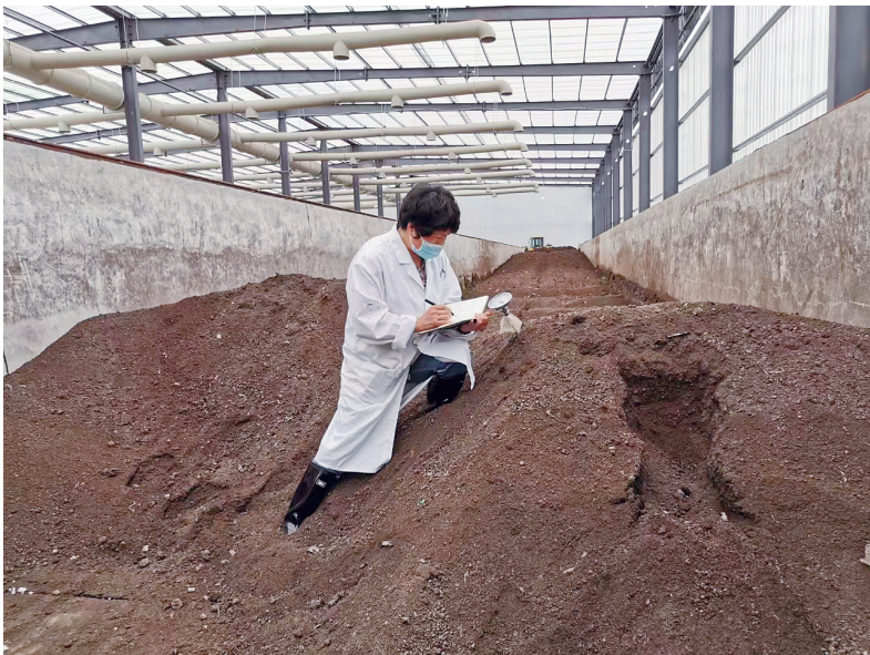
青岛市畜牧工作站专业技术人员正在检测康利来生物科技有限公司堆肥的温度。 刘宗正 摄
