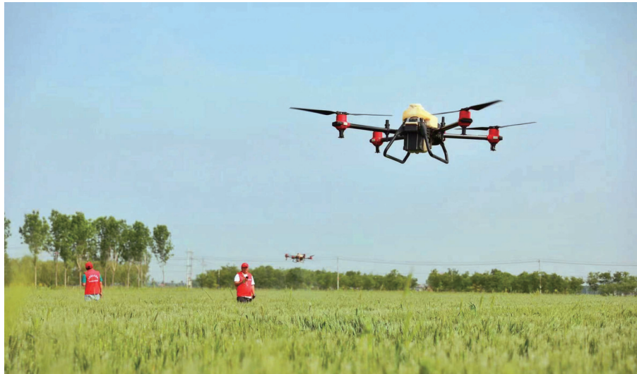
金农田农业机械服务农民专业合作社无人机操作手在托管麦田里进行“一喷三防”作业。资料图
