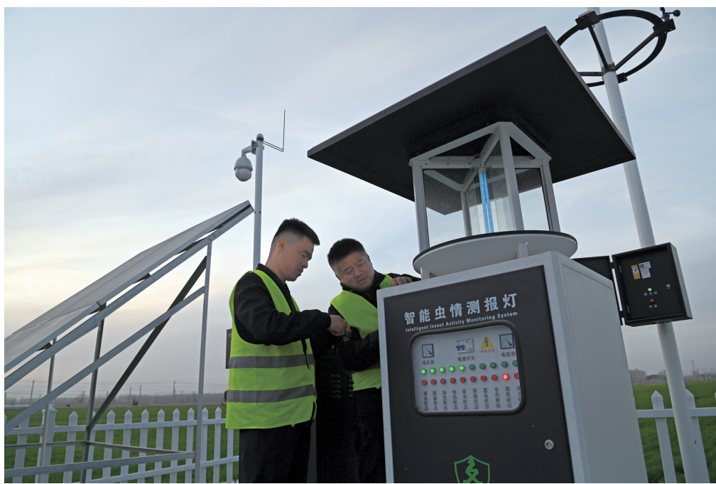
日前，在山东省聊城市东昌府区广平镇四韩村高标准农田物联网监测站，工作人员在调试智能虫情测报灯。据了解，该物联网监测系统由山东祥辰科技集团提供装备和技术支持，能够对周边农田的环境、苗情、虫情、墒情等做到实时监测预警，为智慧春管提供精准依据。 张振祥 农民日报·中国农网记者 吕兵兵 摄
