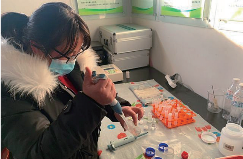
图为村级农产品监管员进行农药残留检测。
