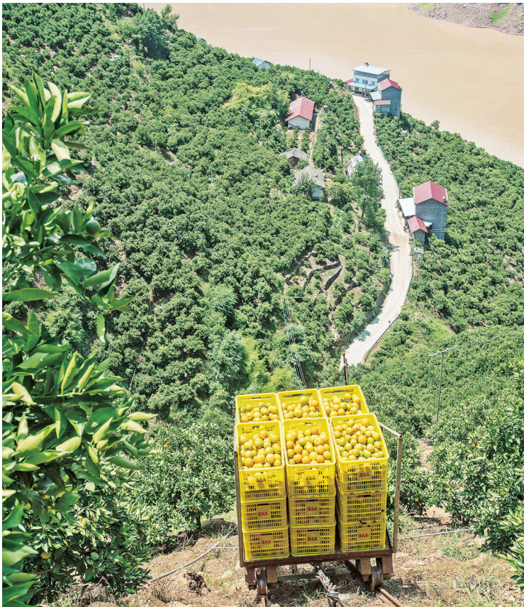
湖北省宜昌市秭归县泄滩乡坊家人村村民利用地面双轨道果园运输机转运刚收获的夏橙。 郑家裕 摄 新华社发
