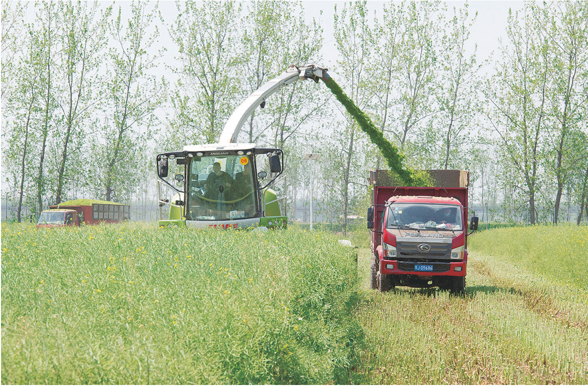
近日，华中农业大学在湖北省仙桃市举行饲料油菜—青贮玉米周年高效种植与利用技术现场观摩会。近年来，华中农业大学油菜团队研究利用冬闲田种植饲料油菜，让油菜“改行”喂牛羊，适口性好，牛羊爱上“油菜配方营养餐”后增重明显，经济效益明显。图为正在机械化收获油菜全株，粉碎青贮后转作饲料，用于喂养牛羊。
