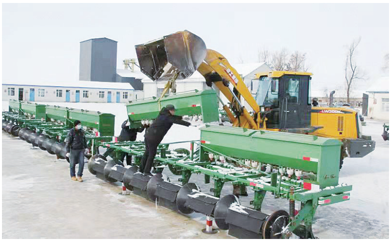
2月16日，在北大荒集团建设农场有限公司第四管理区农机场，管理区农机技术人员正在组织农机工人按照春播农机具检查验收标准，安装调试春播农机具。调试中，农机技术人员向农机工人讲解农机具安装调试保养知识，为春耕生产保驾护航。 许颖献 摄
