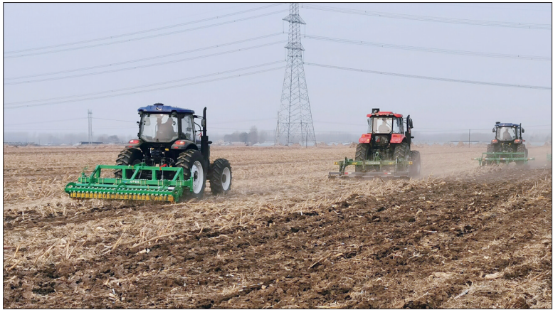
辽宁省铁岭县黑土地保护示范区在开展秸秆机械深松还田作业。
