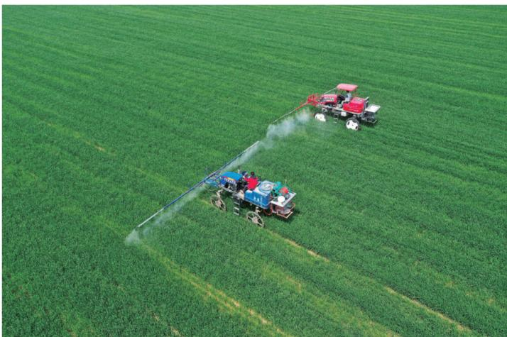
图为安徽省蒙城县楚楼村农民利用轮式喷杆喷雾植保机为小麦喷洒防治蚜虫和锈病的农药。胡卫国 摄
