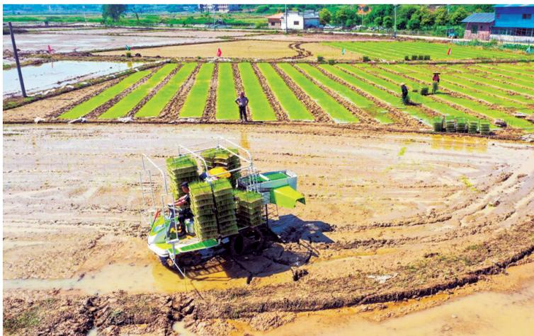
近日,在湖南省邵阳县下花桥镇大现村省级种粮大户王竹生的“农旅生态香稻田”基地里,农机手正抓紧时间驾机插秧。随着该县第一台水稻有序抛秧机匀速向前推进,秧苗便整齐有序地立于田中。据悉,该台抛秧机采用全新高速有序抛秧技术,最高工作效率可达每小时12亩。
