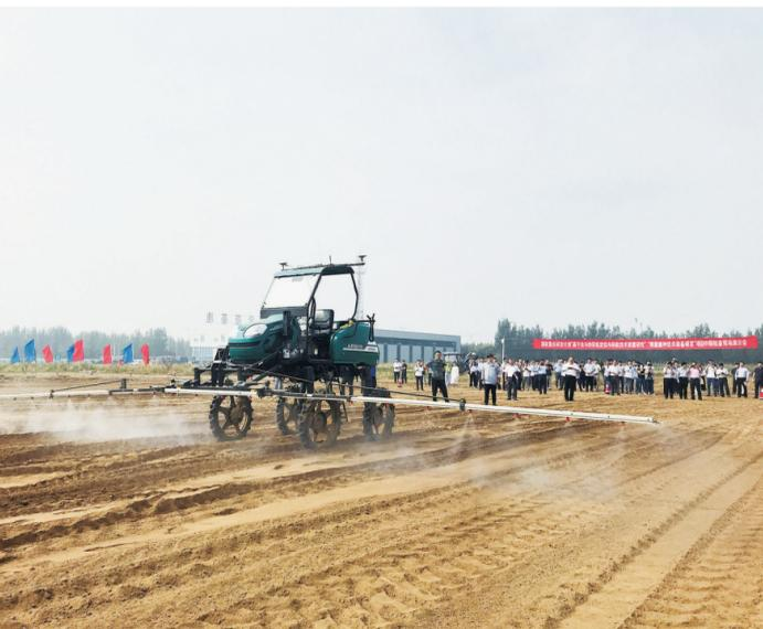
图为具备无人驾驶、自动导航功能的雷沃阿波斯拖拉机,正在进行植保作业展示。
