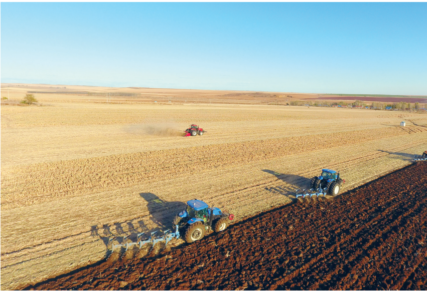
大型配套农机具在内蒙古阿荣旗长发项目区进行“黑土地秸秆二次粉碎+深翻深混”作业。 农业农村部耕地质量监测保护中心提供
