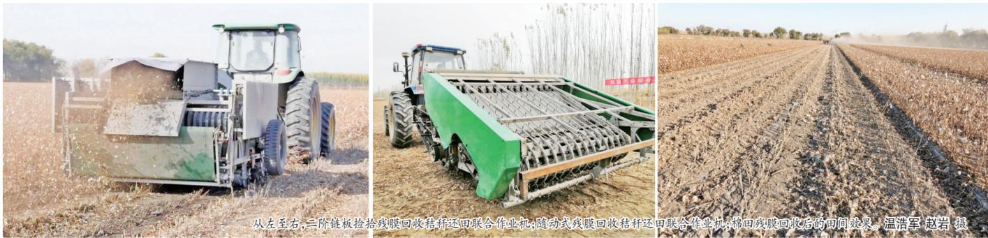
从左至右,三阶链板捡拾残膜回收秸秆还田联合作业机;随动式残膜回收秸秆还田联合作业机;棉田残膜回收后的田间效果。温浩军 赵岩 摄
