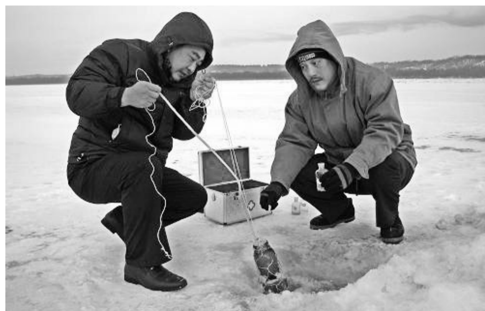
图为2008年12月19日,黑龙江边渔政管理站工作人员在封冻的黑龙江黑河段上马厂水文站横断面提取水样。
