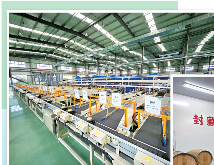
▲大团镇南汇水蜜桃分拣分级处理流水线作业现场。
