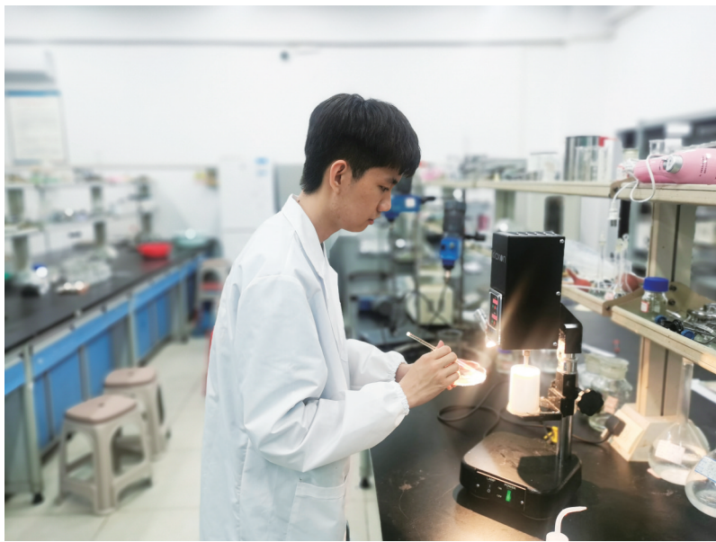
技术人员在海南大学实验室里检测无氨胶乳的机械稳定性。受访者供图
