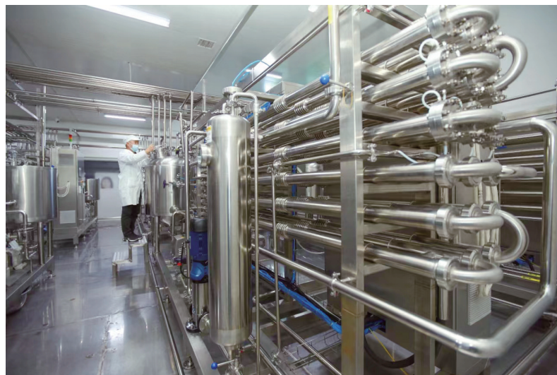
示范区内贵州山王果健康实业有限公司刺梨果汁灭菌车间。
