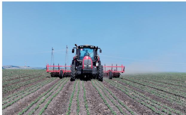
图为内蒙古呼伦贝尔农垦大兴安岭甘河农牧场分公司基层农业生产连队正在进行大豆田夏管机械除草作业。这种机械化除草模式能有效提高地温,减少农药使用量,降低农药残留。
