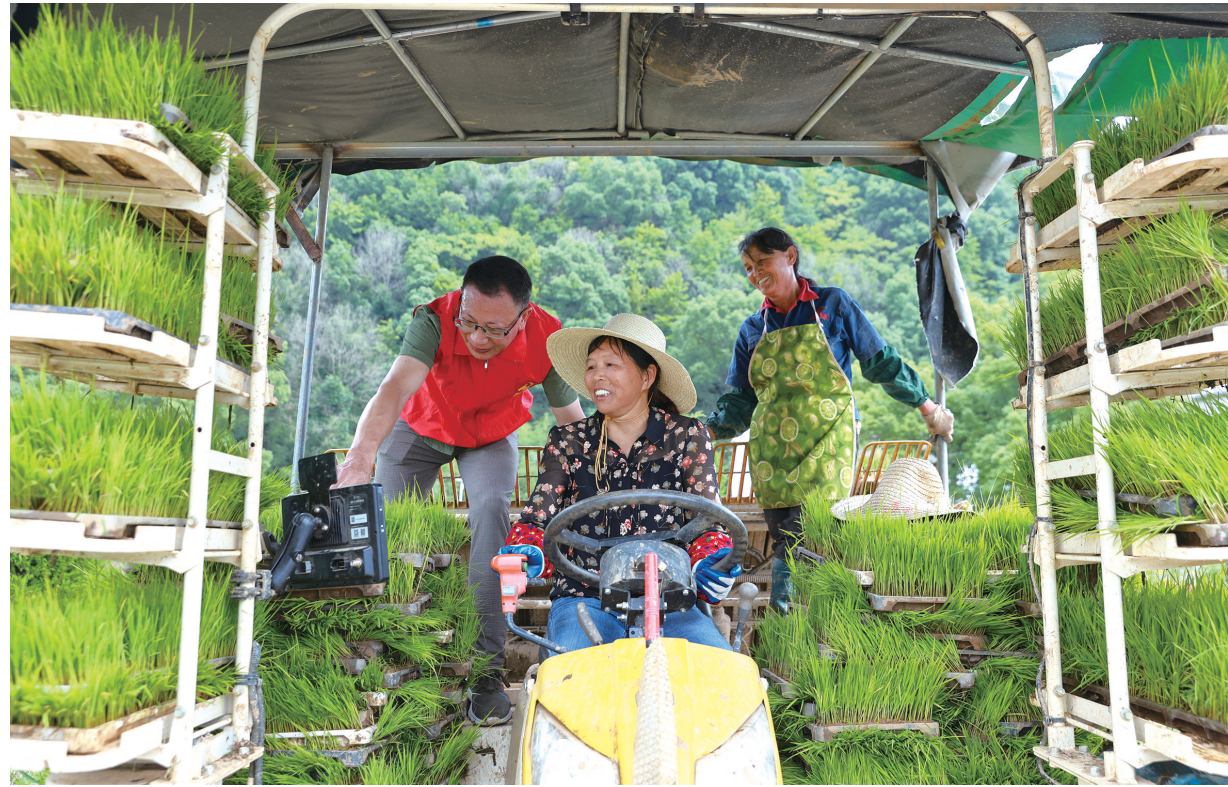
近日，江西省南昌市进贤县北溪村，农技人员正在指导农机手安装使用北斗导航农机自动驾驶设备，准备栽插中稻。复种夏管时节，南昌市组织农技人员深入田间地头，采取“现场培训+实地指导+操作演示”的方式，帮助农户安装使用北斗导航农机自动驾驶设备，实现无人驾驶机插秧，省工又省力。
