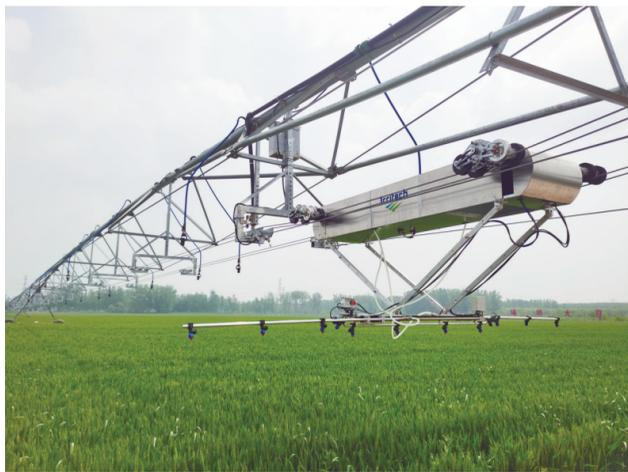
加装在大型喷灌机桁架下的多功能喷药小车预备进田撒药。
