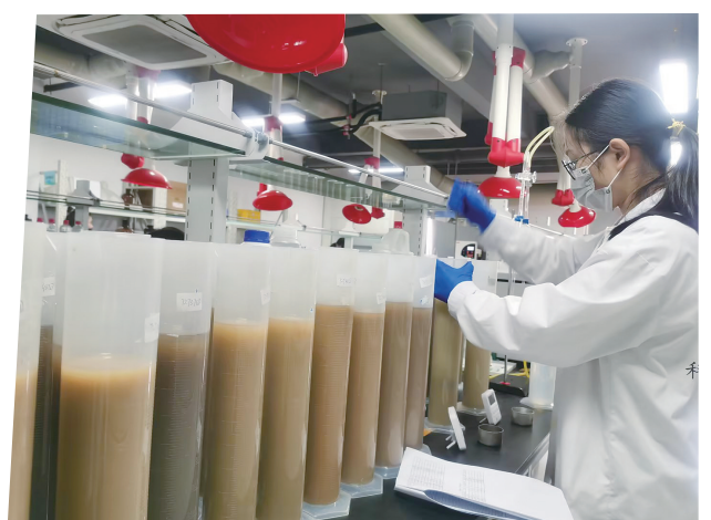
广西土壤普查检测人员进行土壤机械组成检测。
