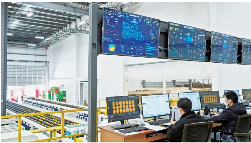
工作人员利用视觉分选系统对柑橘进行瑕疵检测分选，提升产品品质。受访者供图
